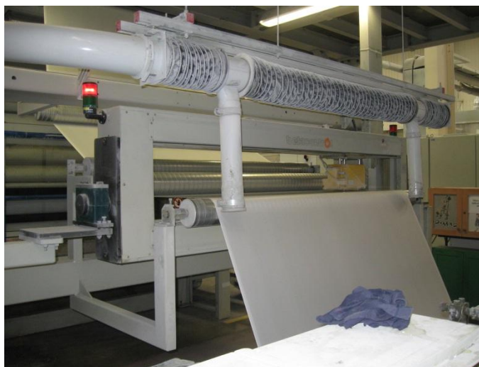
Obrázek č. 11 – Kontaktní snímač – kontrola vrstvy plastu
