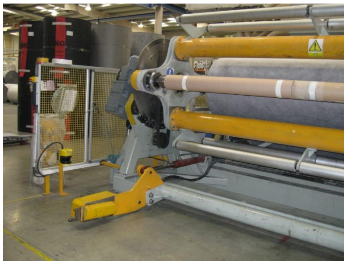
Obrázek č. 18 - Zóna zákazu vstupu za chodu stroje
