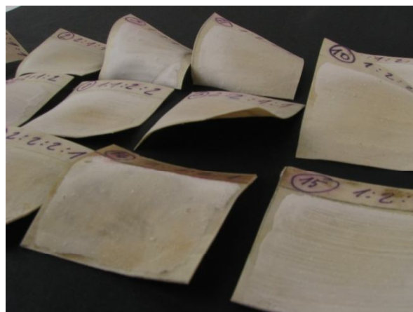
Obr. 202 Detail vzorků po uměleém stárnutí
