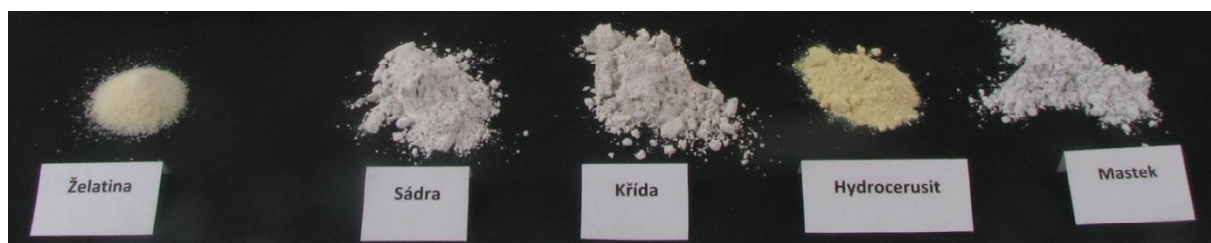
Obr. 191 Jednotlivé složky pro výrobu vzorků
