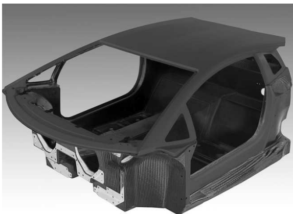
Obr. 1 Karbonové šasi vozu Lamborghini Aventador[4]
