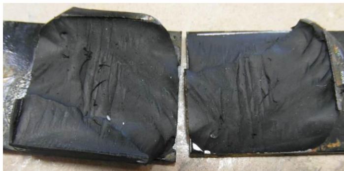
Obr. 40 - příklad kohezního lomu
