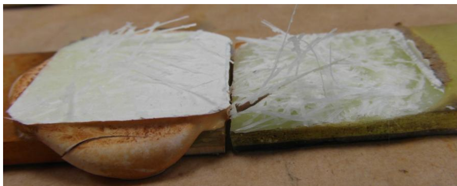
Obr. 64 - narušení základního materiálu na vzorku 3.7M
