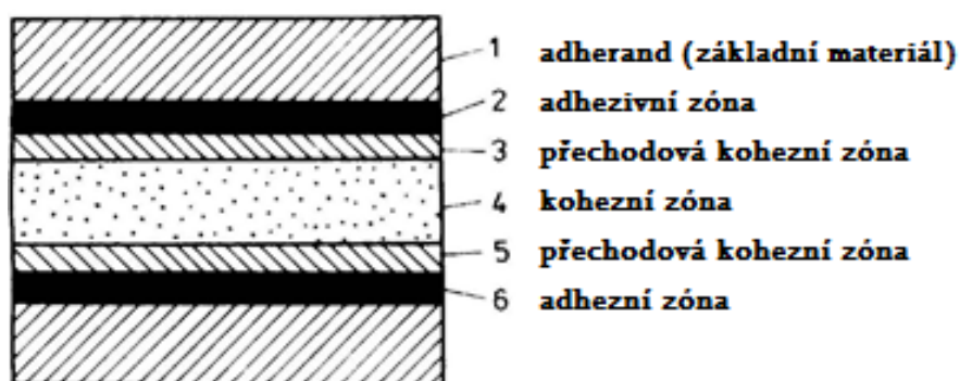
Obr. 2 - řez lepeným spojem [6]
