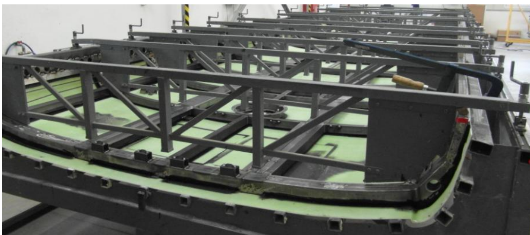
Obr. 31 - speciální přípravek k lepení střechy
