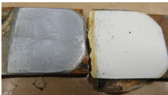
Obr. 56 - adhezni porušení na vzorku 1.6T
