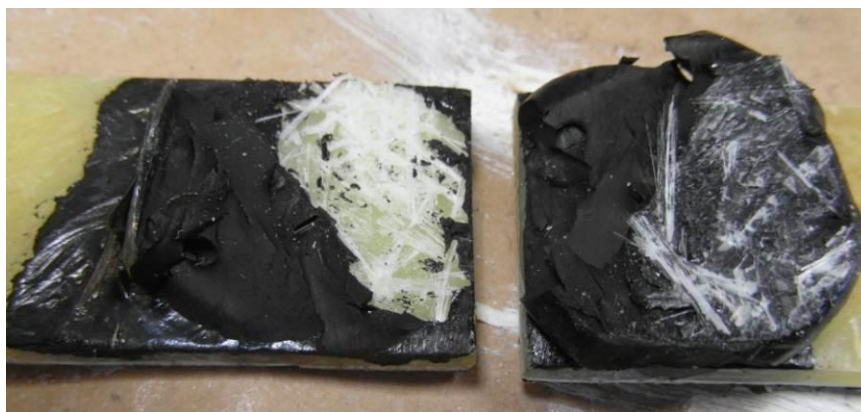
Obr. 46 - narušení základního materiálu na vzorku 4.7M
