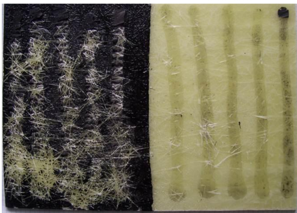
Obr. 51 - adhezní zkoušky na laminátu
