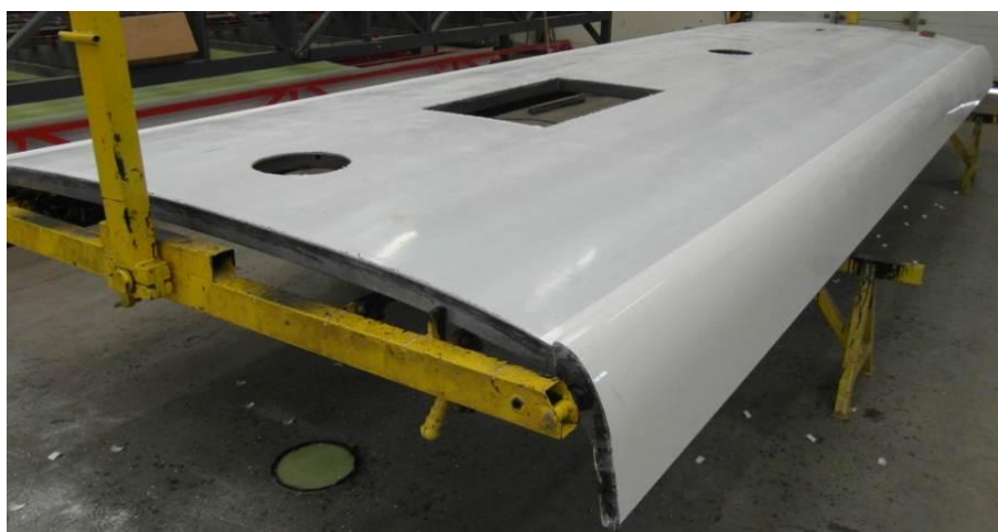
Obr. 25 - konečná podoba slepené střechy
