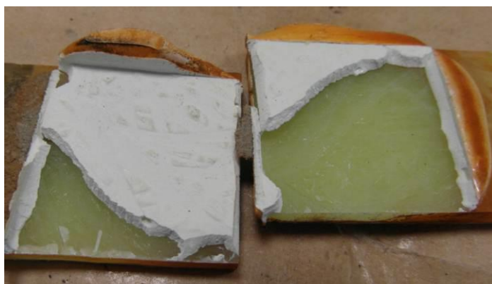
Obr. 68 - adhezní porušení na vzorku 4.4T
