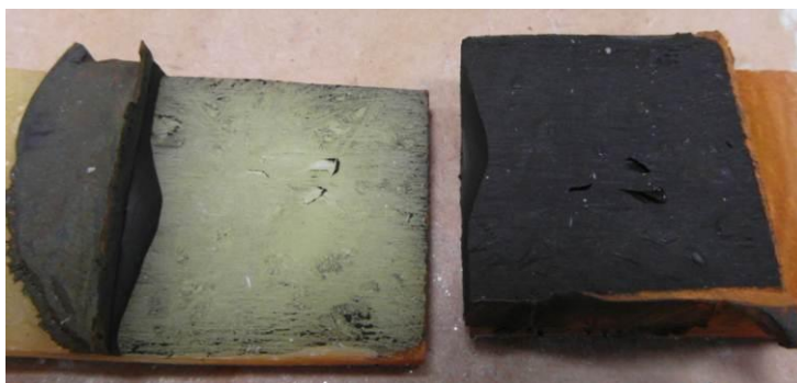
Obr. 44 - smíšený lom na vzorku 3.4.T
