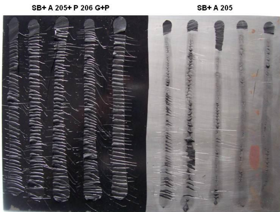
Obr. 49 - adhezní zkoušky na ocelovém plechu
