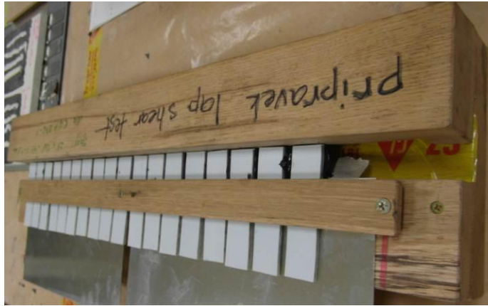
Obr. 32 - slepené vzorky zatížené lisovací silou
