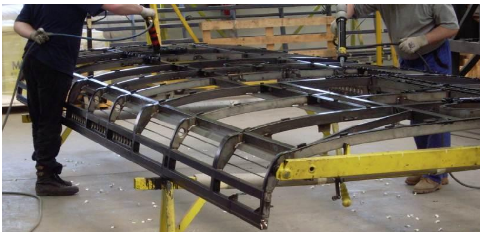
Obr. 30 - aplikace lepidla na nosný rám střechy pomocí pneumatických pistolí
