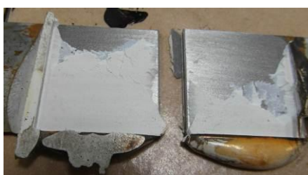
Obr. 60 – smíšené porušení na vzorku 2.4T
