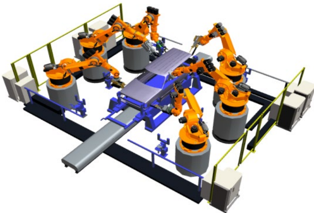
Obr. 2.2. Ukázka svařovacího pracoviště v programu KUKA SimPro
