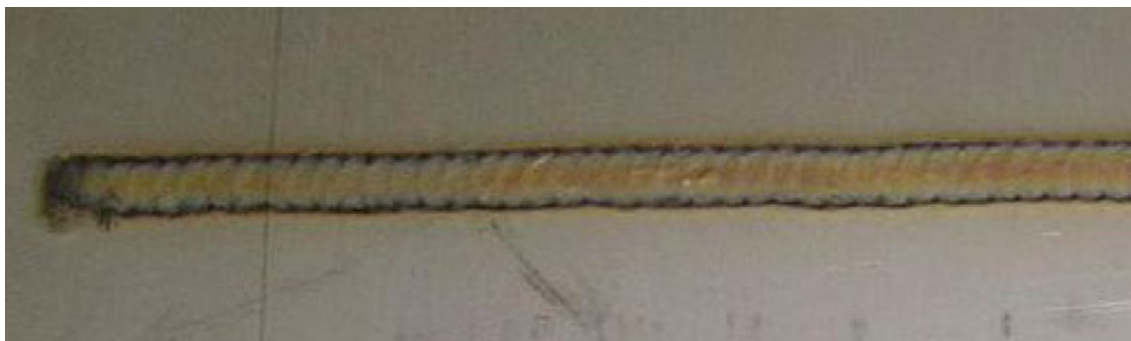
Obr. 4.6. Svár vytvořený metodou švového svařování
