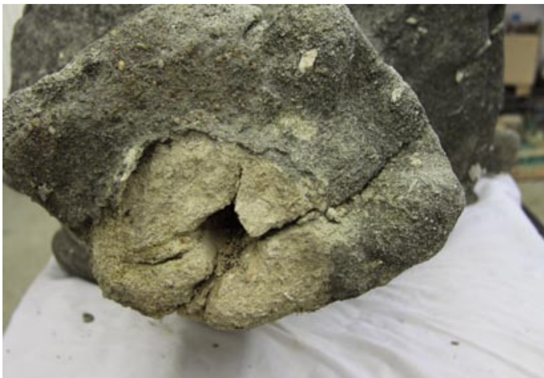
Obr. 58. Váza pravá- detail prasklin od železného čepu- před restaurováním
