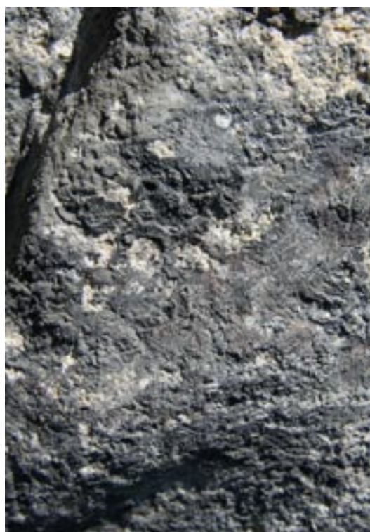
Obr. 18. Sv. Jan Nepomucký- před restaurováním- detail fragmentů polychromní úpravy a černých kruz- čelní strana
