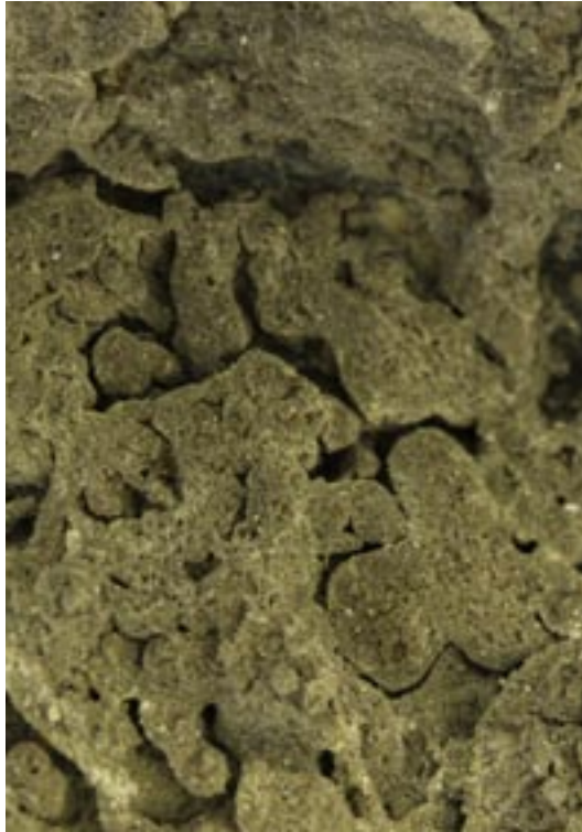
Obr. 7. Detail povrchu sádrovcové krusty
