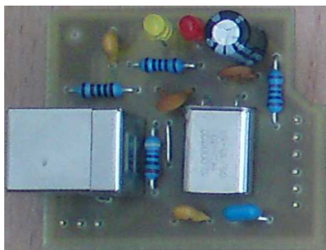
Obrázek 5.9 - Finální podoba komunikačního rozhraní USB 2.0 - UART
