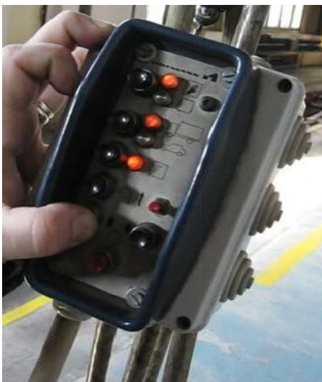
Obr. 6-3 - Původní provedení kabelového dálkového ovládání
