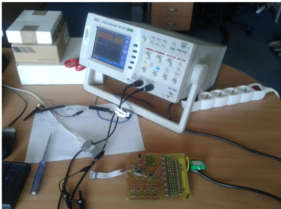
Obr. 8-3 – Čtení přijatých dat na přijímacím modulu
