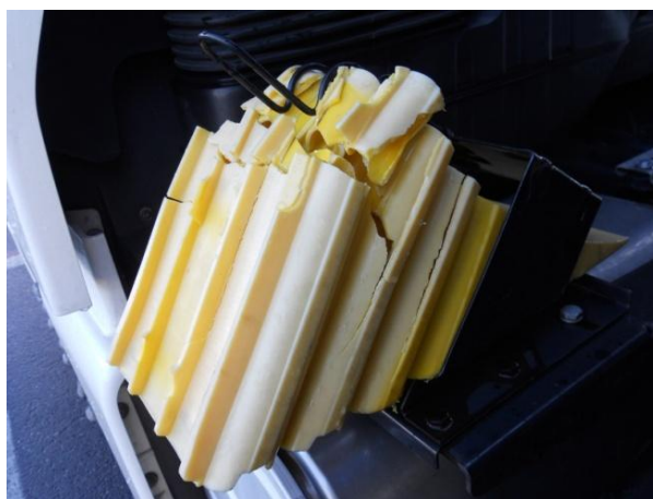
Obrázek 14 Poškozený zakládací klín
