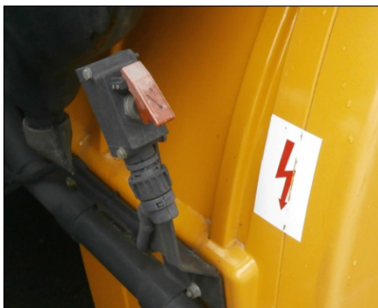
Obrázek č. 4: Odpojovač akumulátoru
