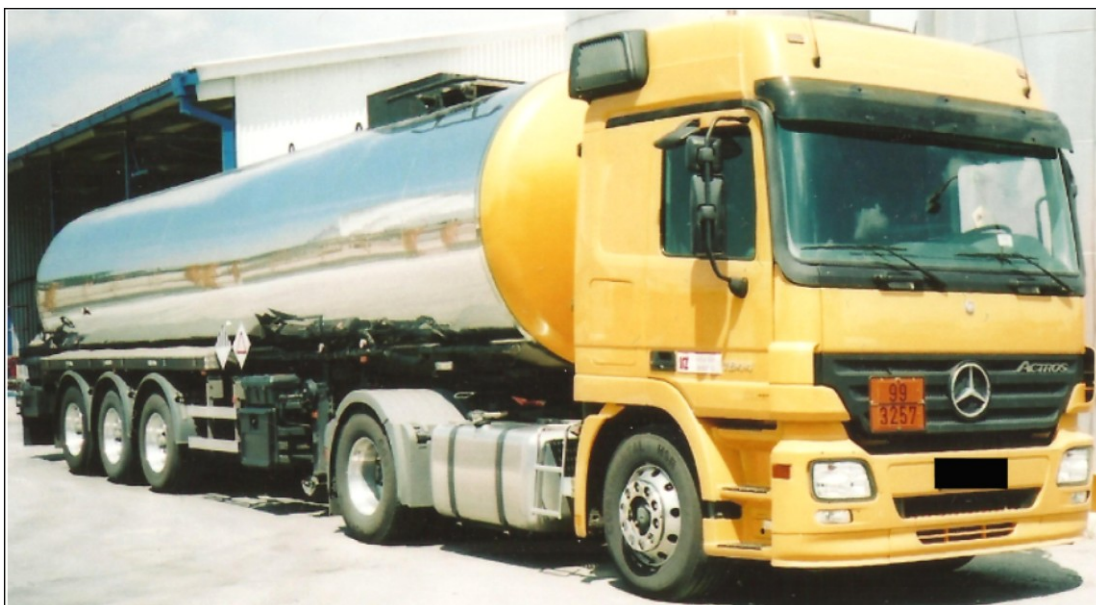
Obrázek č. 16: Souprava tahače a návěsové cisterny pro přepravu nebezpečných věcí
