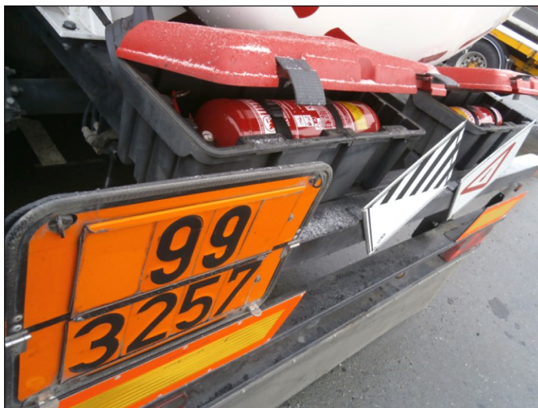
Obrázek č. 17: Boxy s hasicími přístroji v zadní části návěsové cisterny
