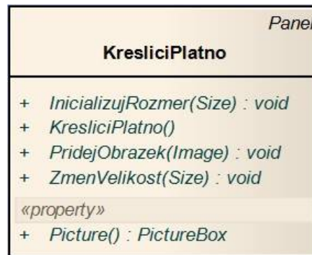
Obrázek 23 - UML diagram třídy KresliciPlatno
