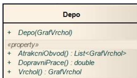
Obrázek 19 - UML diagram třídy Depo
