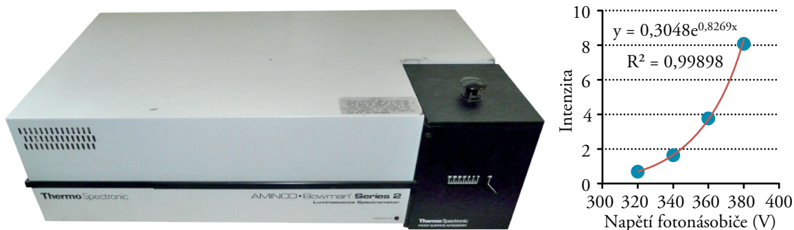
Obrázek 3.6 Přístroj Aminco Bowman Series 2 (vlevo) a závislost intenzity signálu na napětí (vpravo)
