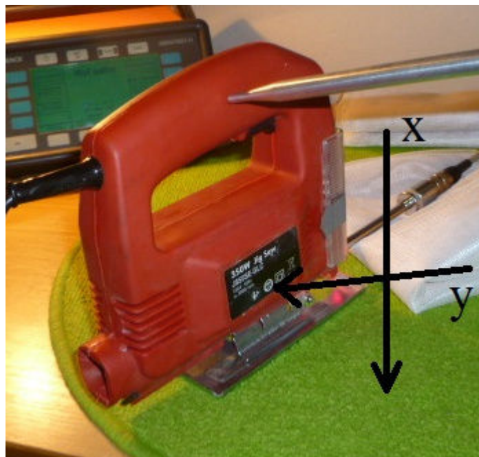
Obr. 17 Směry měření vibrací
