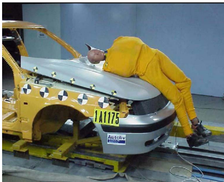
Obr.13: Ukázka nárazu figuríny do aktivované aktivní kapoty. [21]
