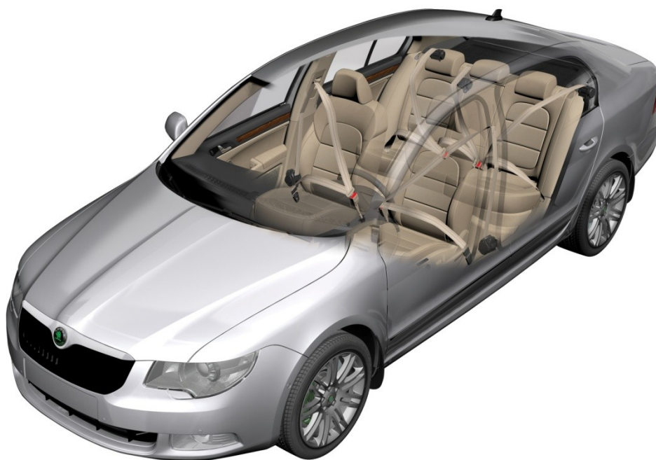
Obr. 4: Umístění bezpečnostních pásů ve vozidle Škoda Superb II. [20]
