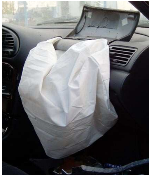
Obr. 6: Airbag spolujezdce umístěný v palubní desce. [16]
