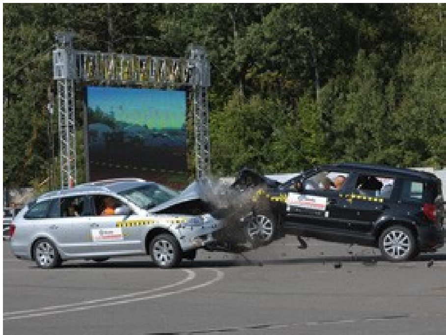
Obr. 14: Náraz v 90 km/h Škoda Yeti do stojícího Škoda Superb. [20]
