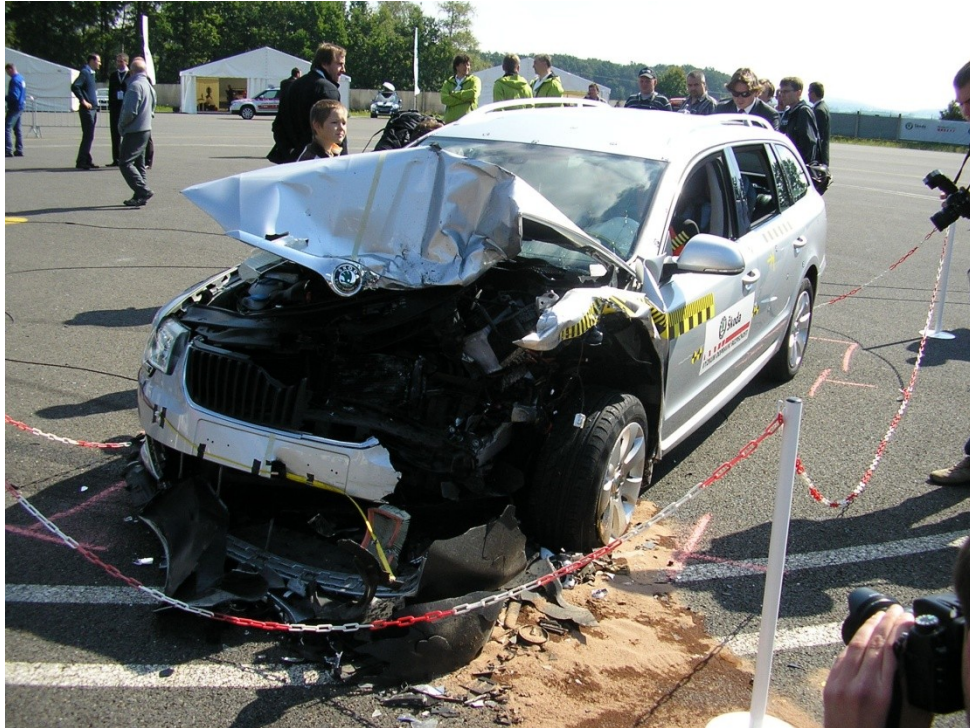
Obr. 16: Poškození na vozidle Škoda Superb po srážce.[22]
