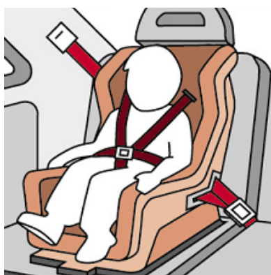
Obr. 9: Uchycení sedačky bezpečnostním pásem. [17]
