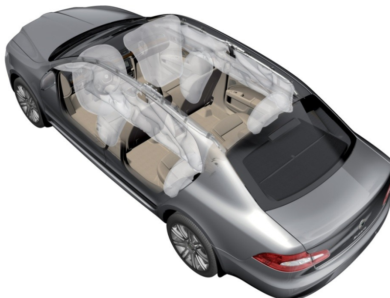
Obr. 8: Umístění airbagů ve vozidle Škoda Superb II. [20]
