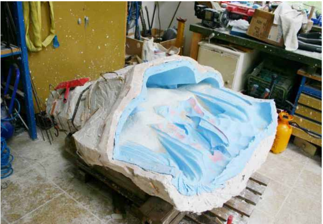
58. Průběh plnění formy
