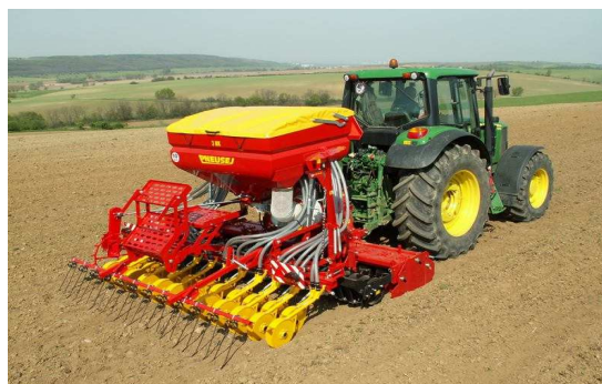
Obr. 2: Výsevná sekcia disková dvojkotúčová pri práci (www.pnusej.sk)
