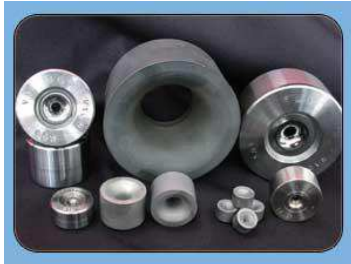
Obr. 2: průvlaky drátů vyrobené z karbidů wolframu [7]
