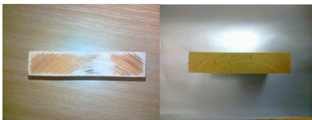
Obr. 2: Změna struktury smrkového vzorku vlivem vlhkosti.
