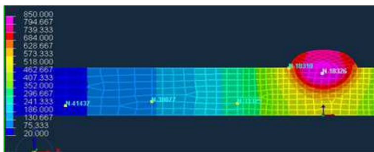
Obr.č.: 5 Umístění termočlánků - simulace (57 mm)
