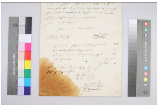
Obr. 41 Čištění olejových zateklin a ukázka jeho účinku na ručním a strojovém papíru
