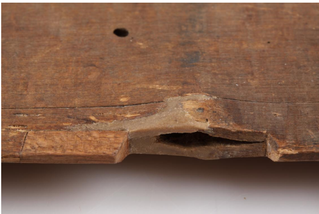
obr. 36) Horní otvor pro uchycení trnu – stav po restaurování
