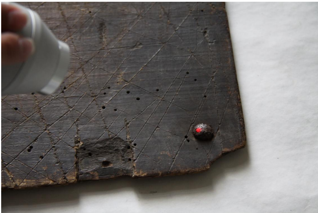
obr. 49) Čištění zkorodovaných hřebů laserovým paprskem
