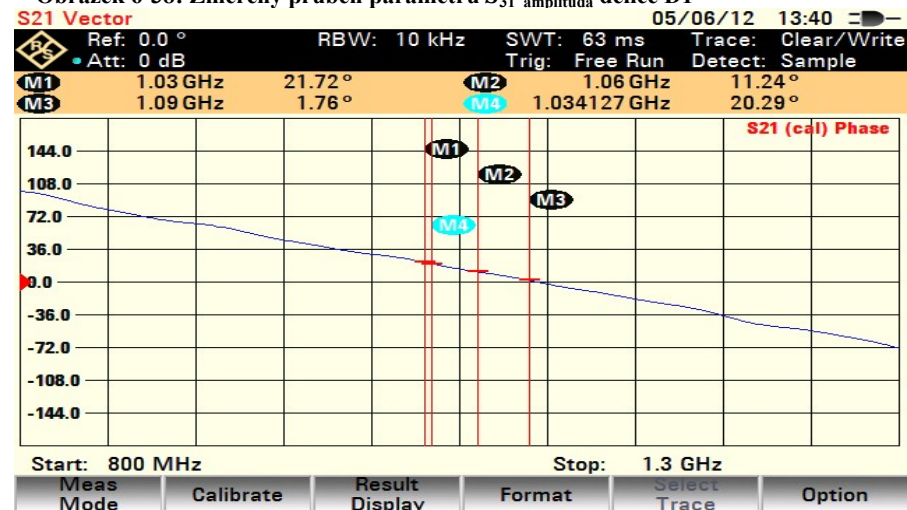
Obrázek 6-40: Změřený průběh parametru S_{31} fáze laboratorního vzorku děliče D1
