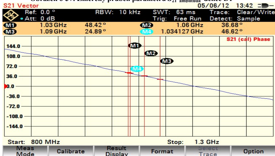
Obrázek 6-39: Změřený průběh parametru S_{21} fáze děliče D1
