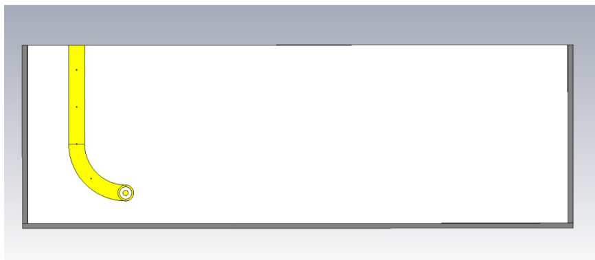
Obrázek 6-8: Model přípravku pro ověřování vlastností kolmého přechodu
