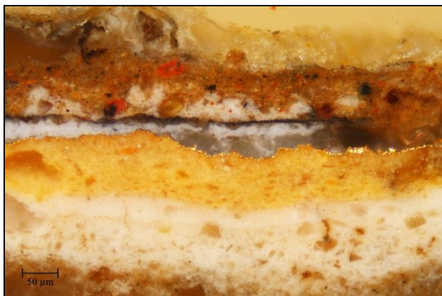
Obr. č. 4: Bílé dopadající světlo, fotografováno při zvětšení mikroskopu 200x – detail barevných vrstev.
