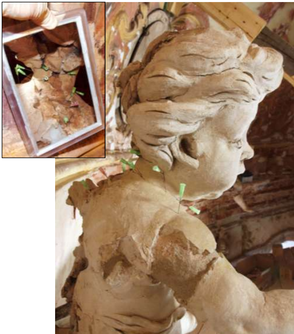
Obr.59. Vlevo: pravá horní polovina plastiky, průběh injektáže - průzkum a „mapování“ trhlin. Průběh prací.
