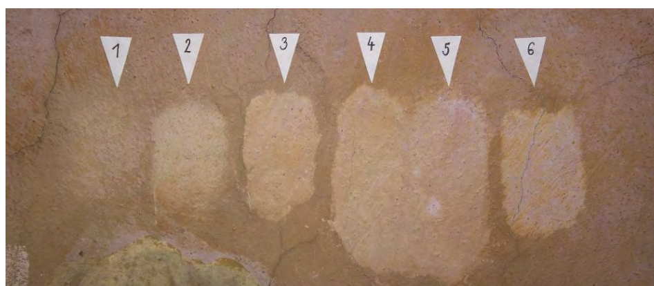
Obrázek č. 33: Zkoušky odstraňování přemaleb v pozadí nad postavou Panny Marie, lokalizace (viz. Příloha 10.2. Grafická dokumentace).
