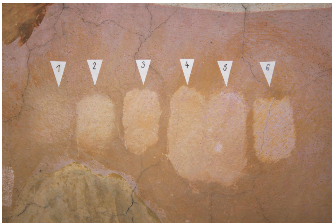
Obr. 48 Zkoušky odstraňování přemaleb v medailonu nad hlavou Panny Marie (popis jednotlivých zkoušek viz. textová část, kapitola 5.4.1 Zkoušky čištění a odstraňování přemaleb).
