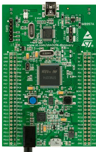
Obrázek 4.20 Vývojový kit STM32F4DISCOVERY [3]
