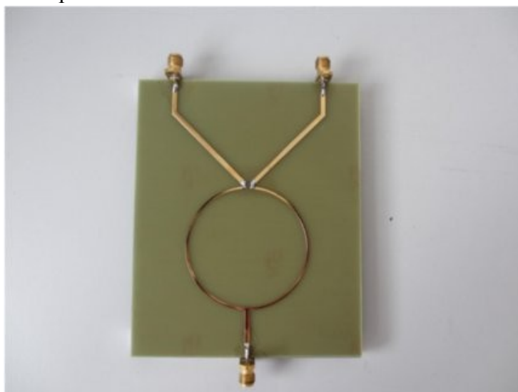
Obr. 6.18 - Dělič 2. MO s přímými rameny, realizován na mikropáskovém vedení
