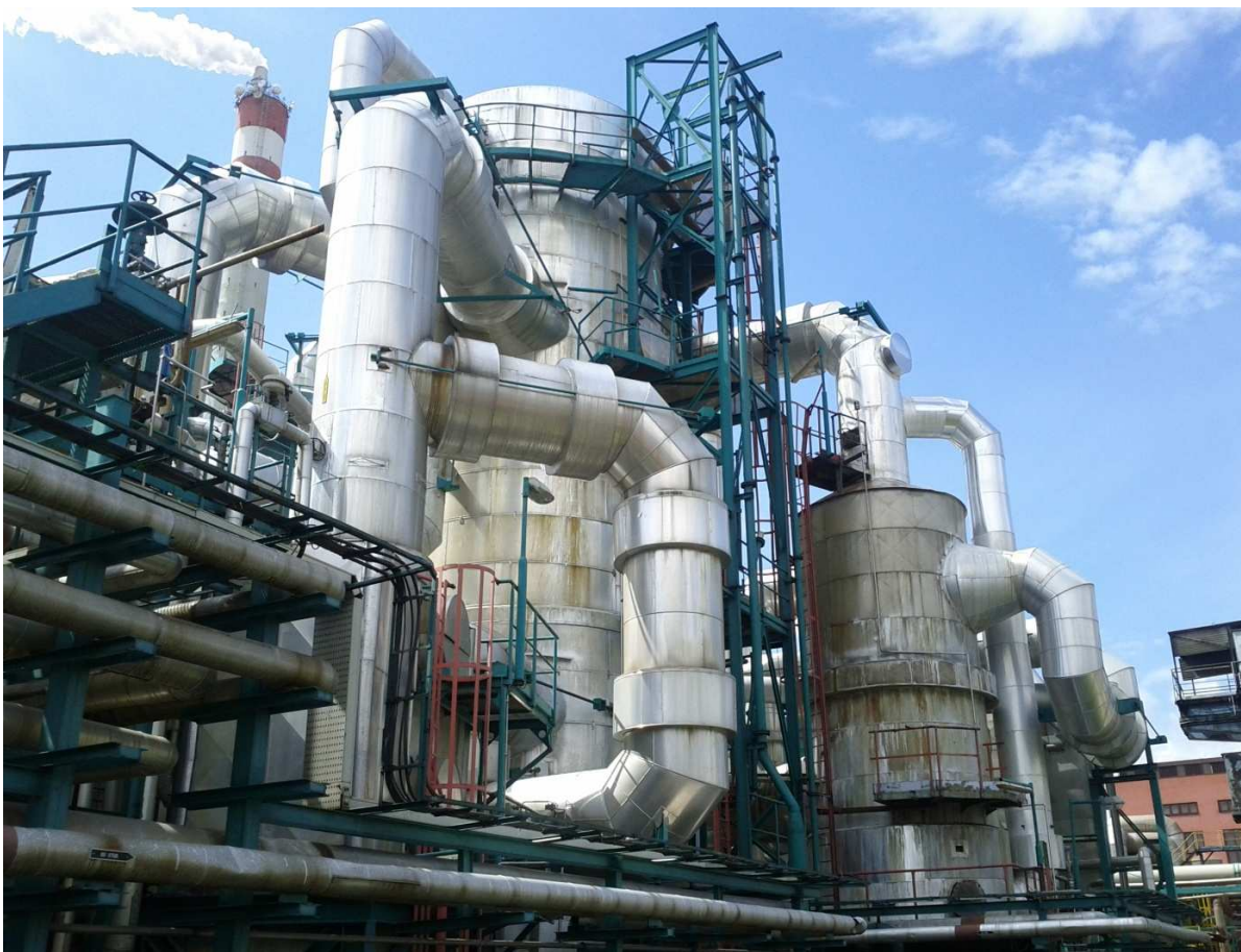
Obr. 5: Etážový reaktor pro katalytickou oxidaci \text{SO}_2
