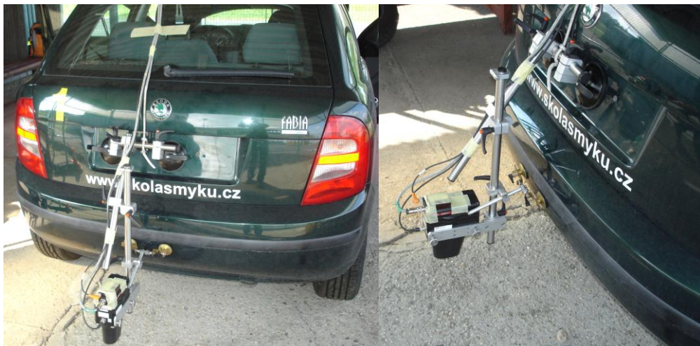
Obr. 76: Umístění snímače Correvit na zádi automobilu
