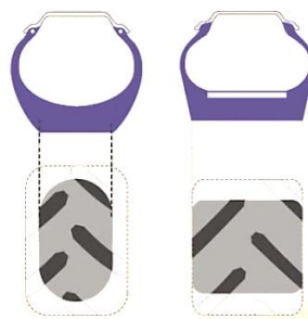
Obr. 42: Změna velikosti styčné plochy diagonální (vlevo) a radiální (vpravo) pneumatiky při změně zatížení (odlehčené pneumatice odpovídá vybarvená plocha) [30]
