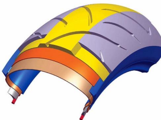
Obr. 16: Vícesložkový běhoun – Dunlop Multi - tread technology [13]
