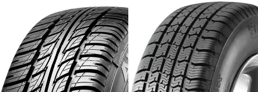
Obr. 28: Symetrický desén letních (vlevo) a zimních pneumatik (vpravo) [20]
