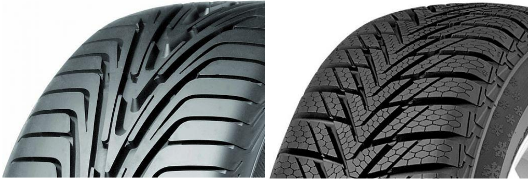
Obr. 31: Směrový desén letních (vlevo) a zimních pneumatik (vpravo) [20]
