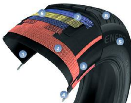
Obr. 2: Řez radiální pneumatikou [4]
