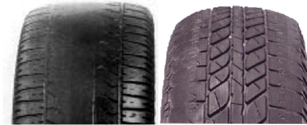
Obr. 54: Typické opotřebení pneumatiky při přehuštění resp. podhuštění [34] a [33]
