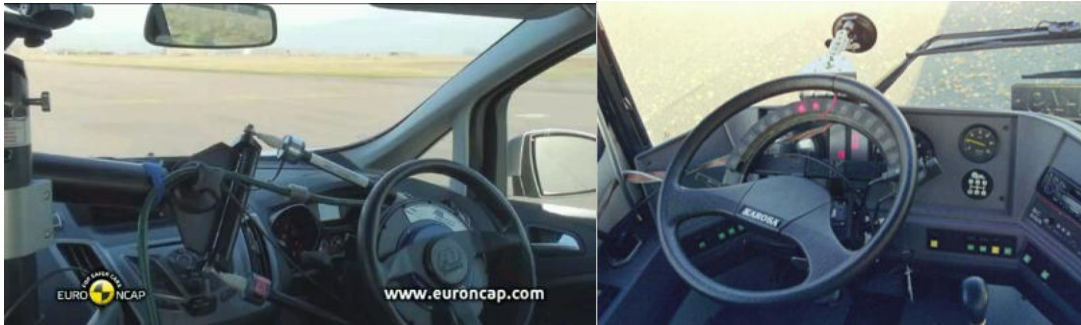
Obr. 55 a Obr. 56: Řídicí robot [36] a světelná rampa [37]
