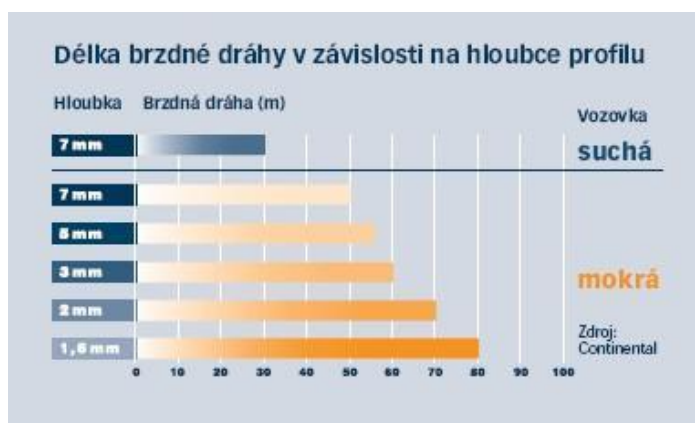
Obr. 33: Závislost délky brzdné dráhy automobilu na hloubce desénu pneumatiky [23]
