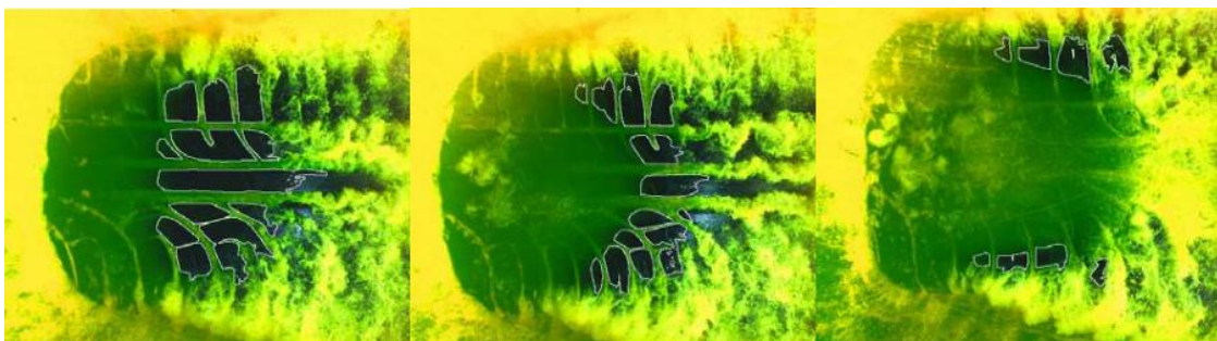
Obr. 40: Vliv tlaku huštění pneumatik na změnu kontaktní plochy a vznik aquaplaningu při rychlosti 80 km/h (Tlak huštění pneumatiky zleva: 200 kPa, 150 kPa a 100 kPa) [29]
