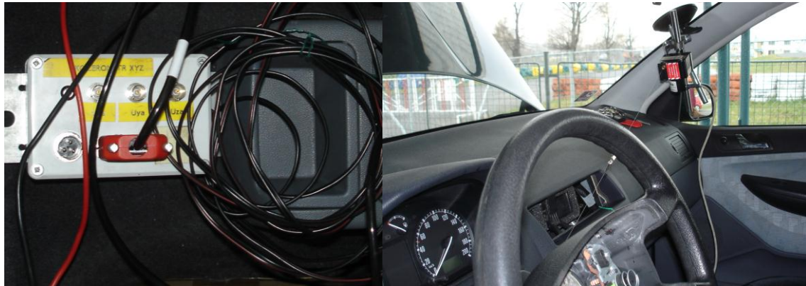
Obr. 75: Umístění snímače zrychlení (vlevo) a snímače úhlu natočení volantu (vpravo)
