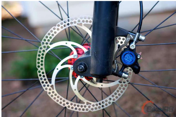
Obrázek 13 Příklad kotoučové brzdy pro použití na jízdních kolech [6]
