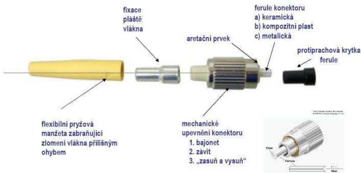
Obrázek 12 – Složení optického konektoru (převzato z [8])
