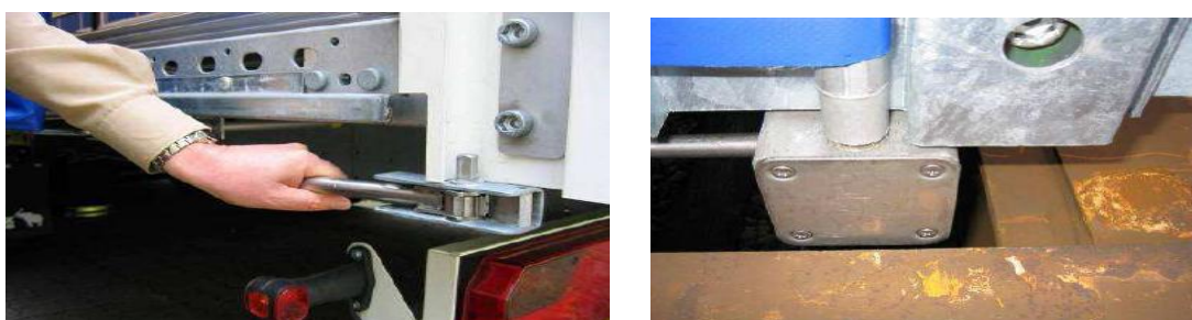
Obrázek 17: Napínání plachty návěsu vlevo nové ploché provedení; vpravo staré
