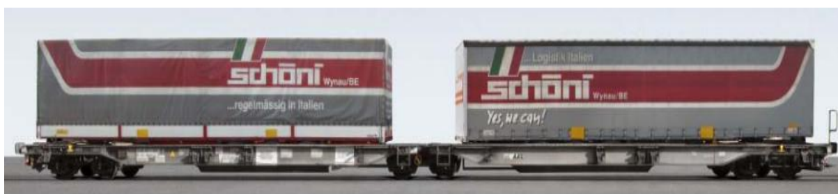
Obrázek 25: Železniční vůz řady Sdggmrss - L
