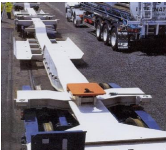
Obrázek 28: Železniční vůz EuroSpine
