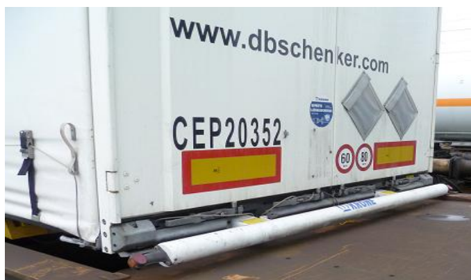
Obrázek 18: Sklopná zadní zábrana proti podjetí osobního automobilu
