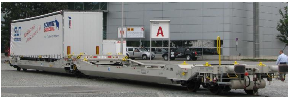
Obrázek 26: Železniční vůz řady Sdggmrss – TWIN
