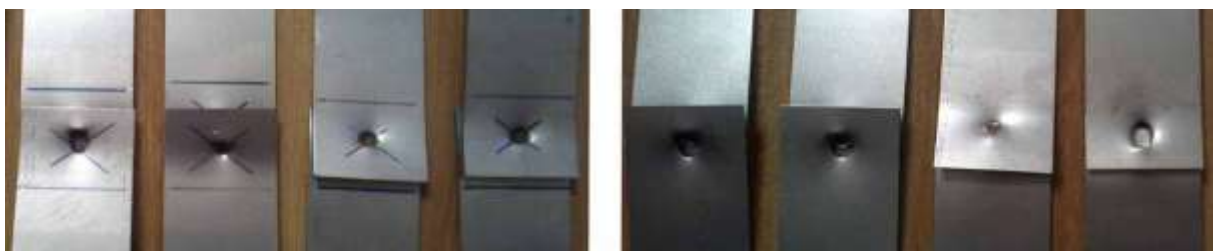
Obr. 15 – Vzorky svařené odporovým bodovým svařováním po sřihové zkoušce
