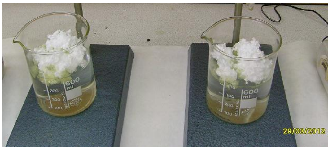
Obr. č. 18 – Testování sypkého sorbentu REOSORB [foto autor]
