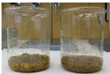
Obr. č. 21 – Sorpce – dřevní piliny [foto autor]
