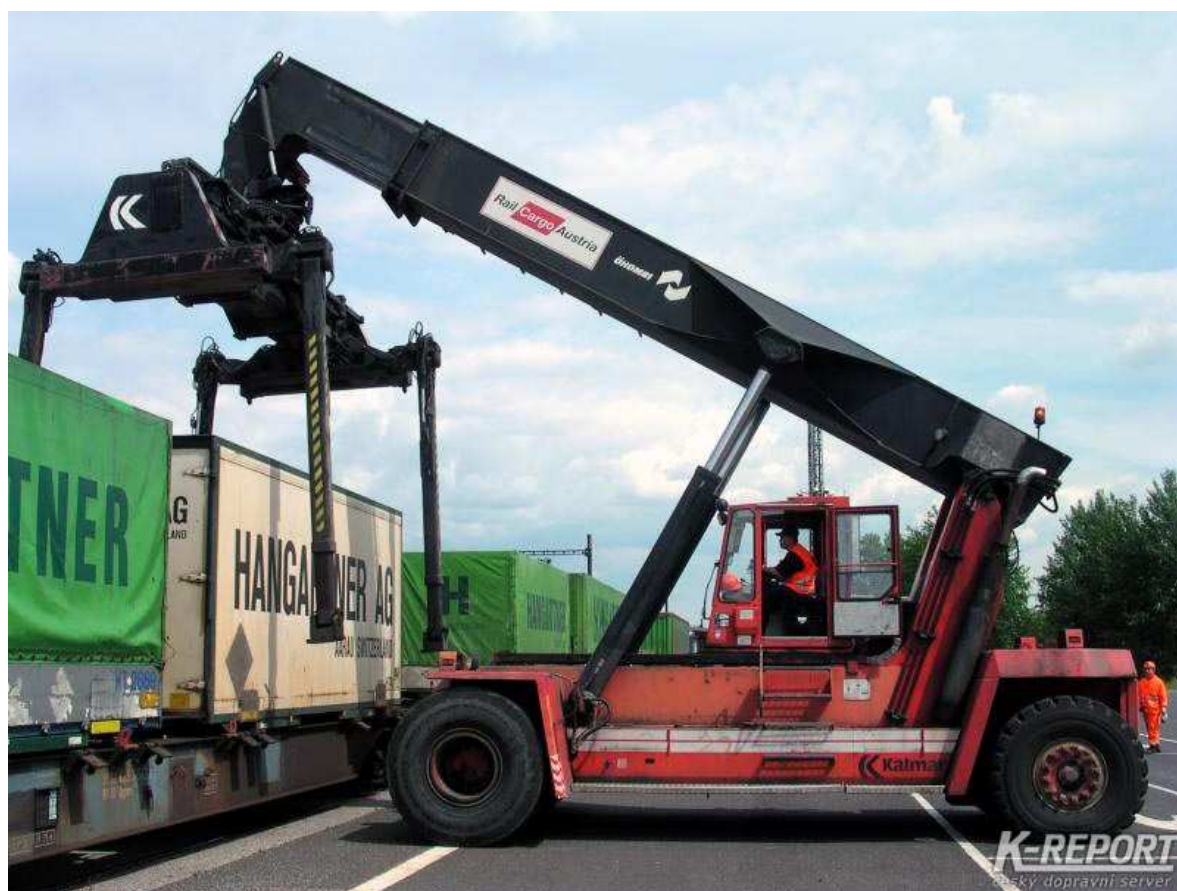
Obrázek 5: Překládka VN pomocí spreaderu s kleštinami
