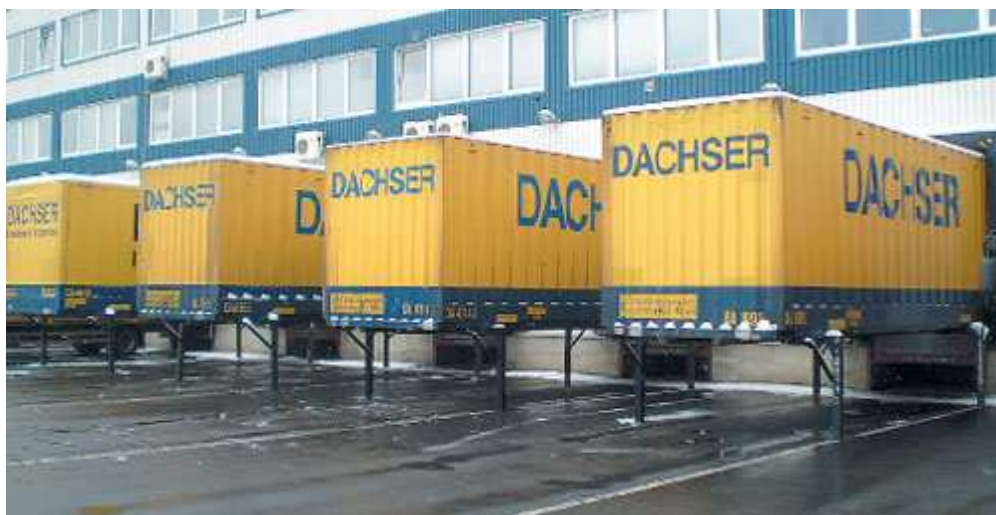
Obrázek 10: VN připraveny k vyskladnění u rampy skladu
