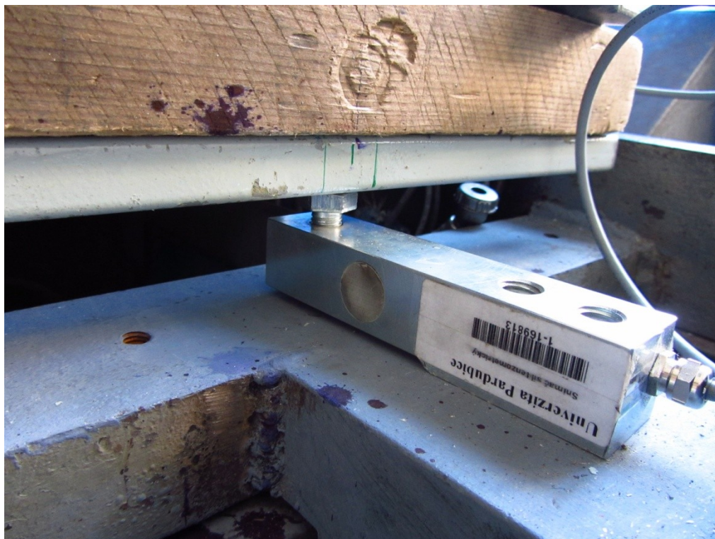
Obr. 14 - Detail snímače síly tvaru ohybového nosníku
