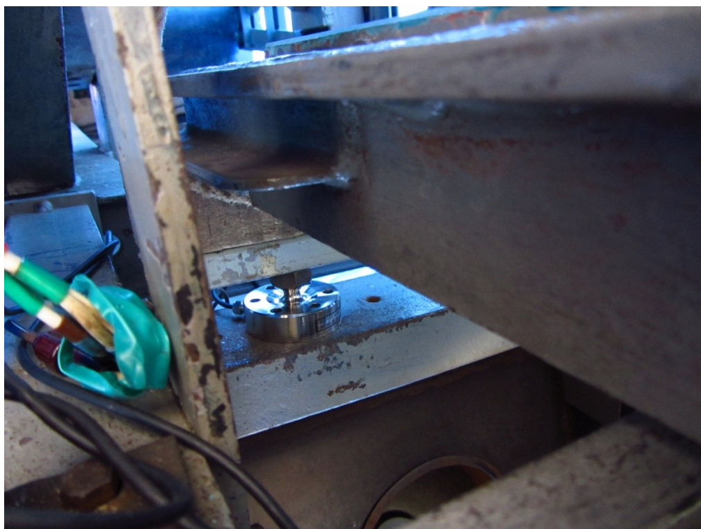
Obr. 15 - Detail snímače síly válcového tvaru
