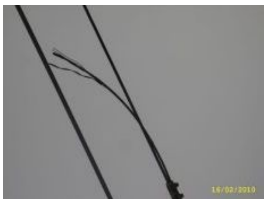
Obr. 2.7, 2.8 – Zbytky lan pevného bodu z případu zasahující do průjezdného profilu (Zdroj Policie ČR)
