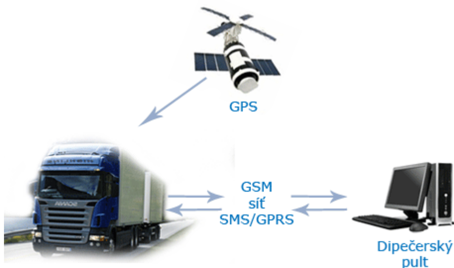
Obrázek 19: Schéma fungování systému EchoTrack
