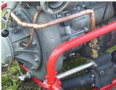
Obr. 35: Úprava potrubí vývěvy [36]
