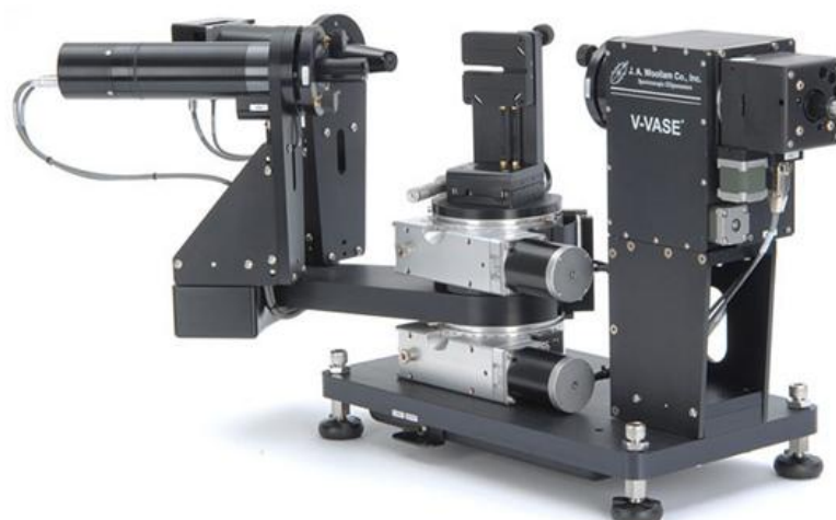
Obr. 13 Spektrální elipsometr s proměnným úhlem dopadu (V-VASE) od firmy J. A. Wollam Co, Inc.
