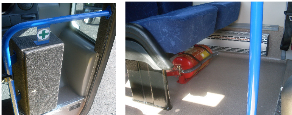
Obr. č. 13: Umístění lékárníčky a hasicích přístrojů
