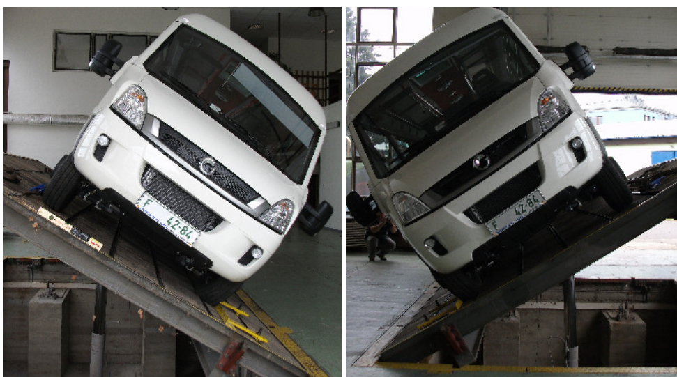
Obr. č. 25: Naklápění autobusu STRATOS LE 37 na levou a pravou stranu
