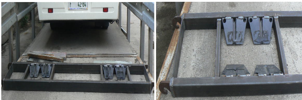
Obr. č. 27: Konstrukce pod kola zadní nápravy
