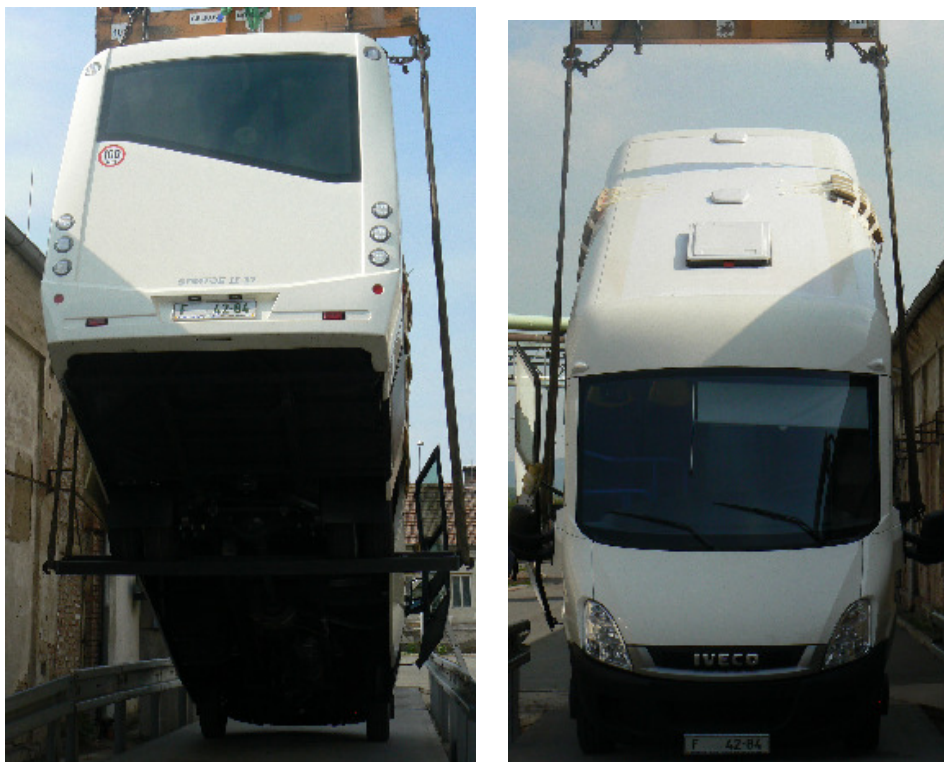
Obr. č. 28: Měření výškové polohy těžiště
