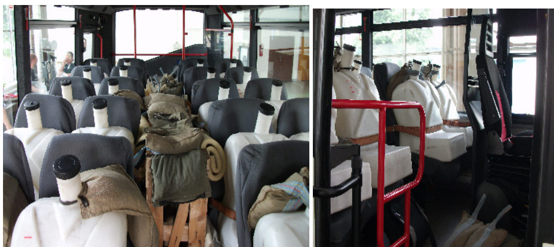
Obr. č. 24: Zatížení autobusu pro zkoušku stability
