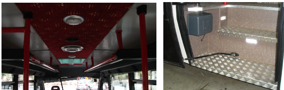
Obr. č. 21: Osvětlení vnitřního prostoru a předního schodu
