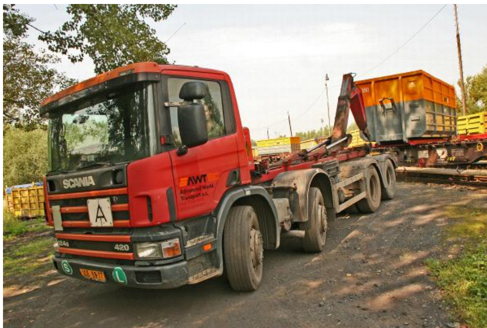
Obrázek 1 Silniční vozidlo s manipulátorem, železniční vůz a kontejner
