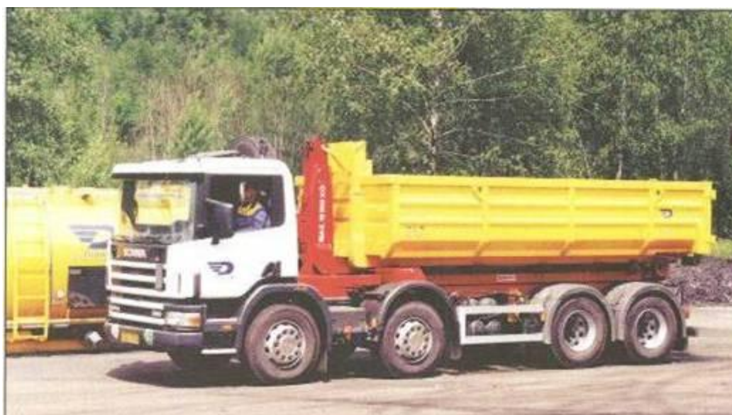
Automobilový nosič / překladač kontejnerů Scania P 124 GB
