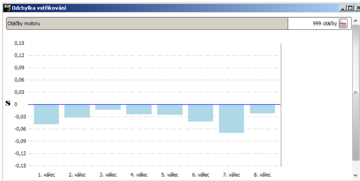
Obrázek 17: Graf s výsledky testu odchylky vstřikování při 999 ot. /min
