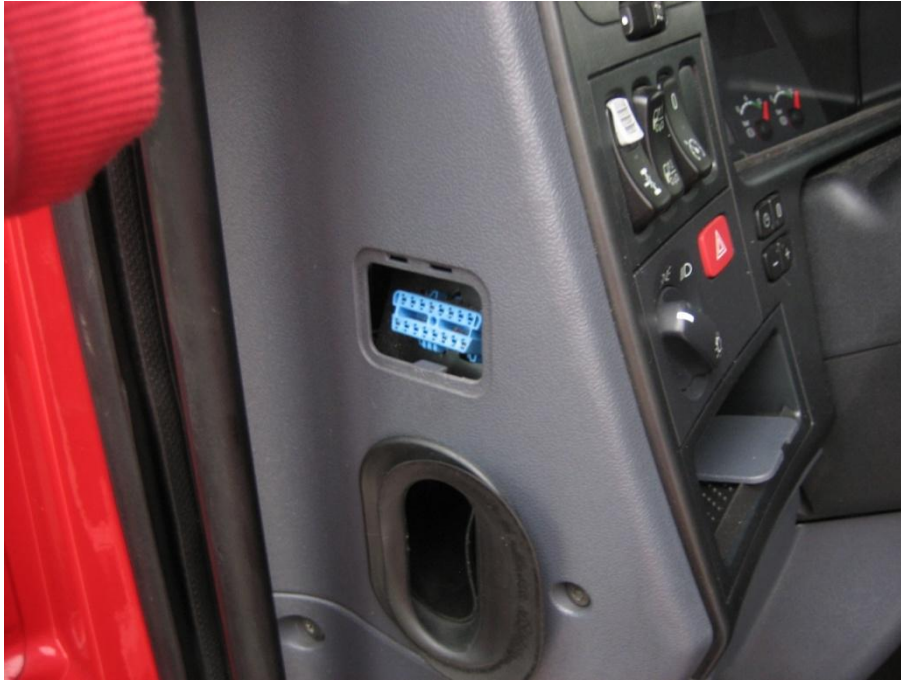
Obrázek 7: Zásuvka pro připojení k počítači s programem SDP3
