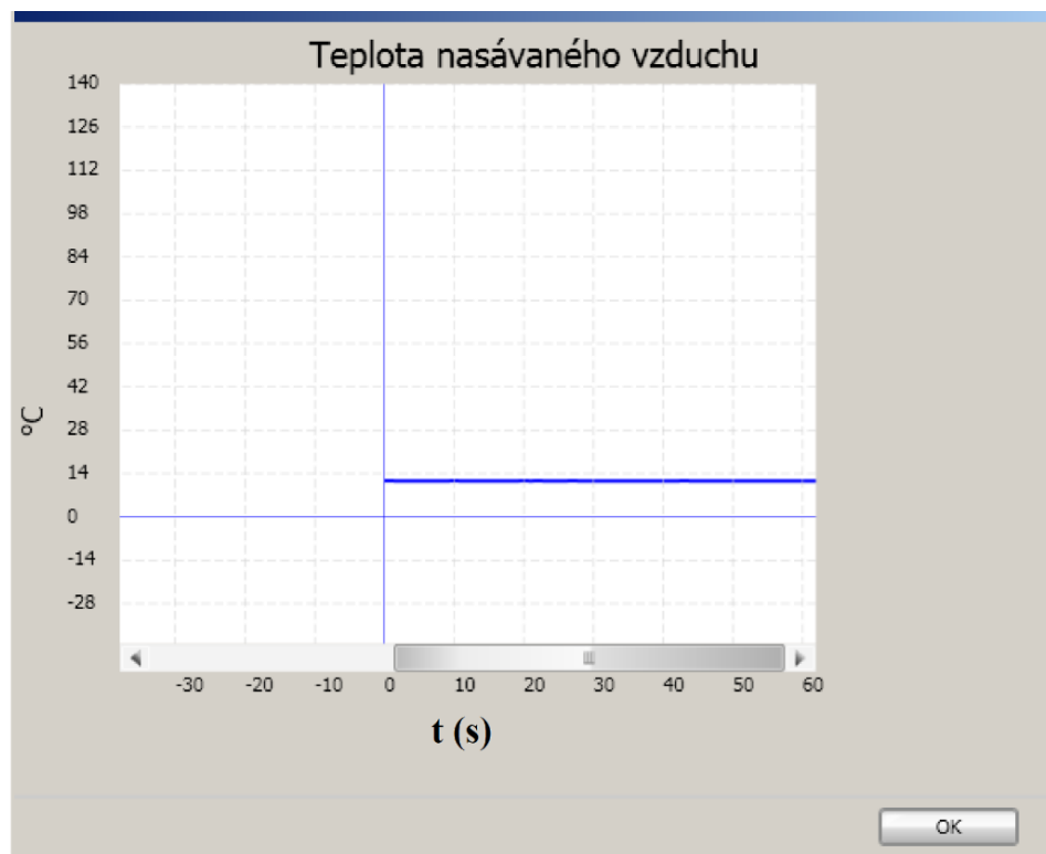
Obrázek 10: Graf s výsledkem měření teploty nasávaného vzduchu
