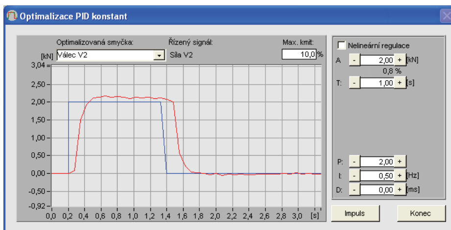
Obr. 5 – Příklad odezvy PID regulátoru při optimalizaci válce
