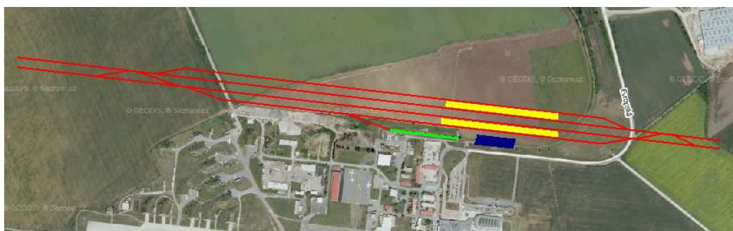
Obr. 14 : Možná podoba stanice. Žlutě jsou naznačena nástupiště, modře výpravní budova s technologickým zázemím, světle zeleně současné kolejiště vlečky v areálu. Zdroj: www.mapy.cz
