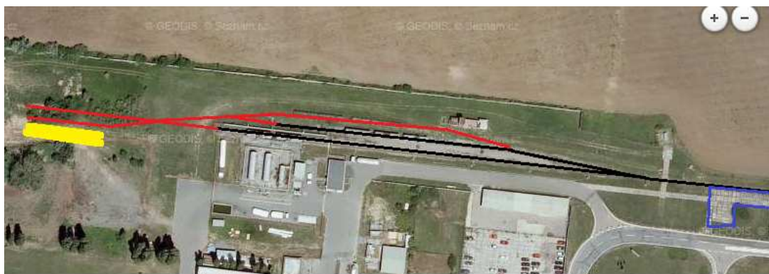
Obr. 8: Úprava kolejiště vlečky (černá – stávající, červená – navrhovaný stav, žluté pole – nová rampa, modré ohraničení – stávající rampa). Zdroj: www.mapy.cz
