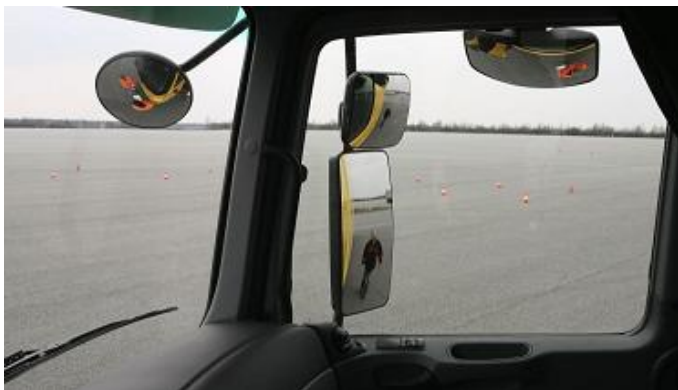
Obr. 4.15 Panoramatická zrcátka pokrývající mrtvé úhly
