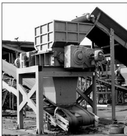
Obr. 3 - drtič s horizontálním rotorem a spodním roštem
