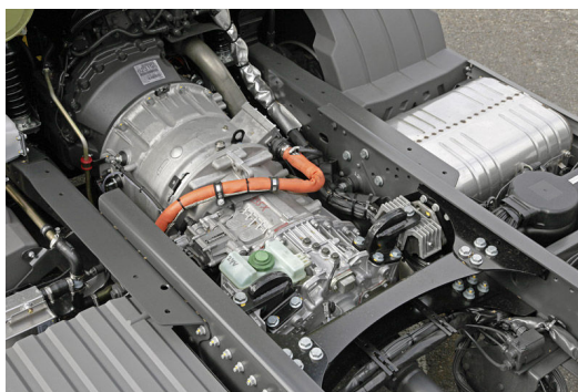
obr. 5.23 Znáznornění zástavby elektromotoru[31]
