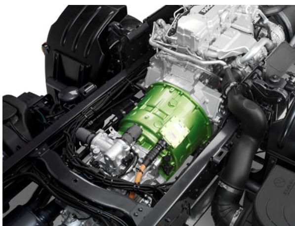
obr. 5.16 Znázornění zástavby elektromotoru DAF[18]
