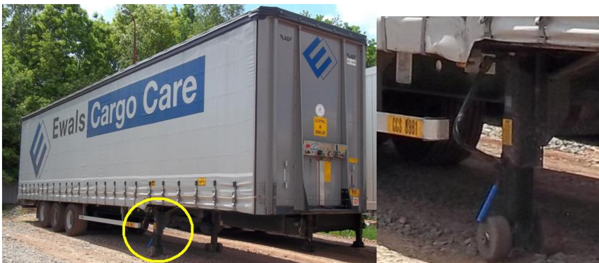
Obrázek 7: Klika k nastavení výšky návěsu
