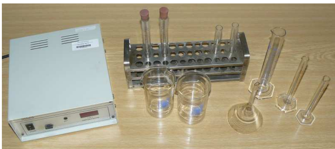
Obr. 16 - Kompletní sestava přístroje REO 31 a pomůcek potřebných k měření [vlastní foto]
