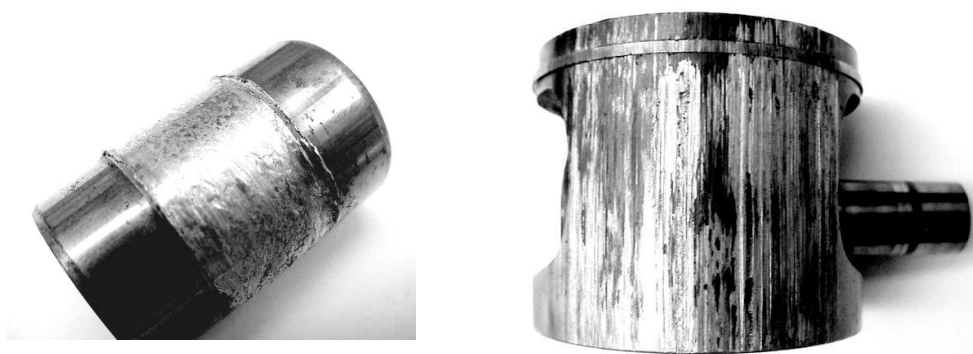
Obr. 5 – Adhezivní opotřebení pístního čepu (vlevo) a abrazivní opotřebení pístu (vpravo) [21]
