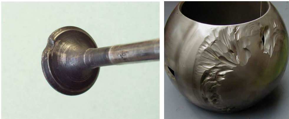
Obr. 7 – Erozivní opotřebení ventilu a koule uzávěru [15]
