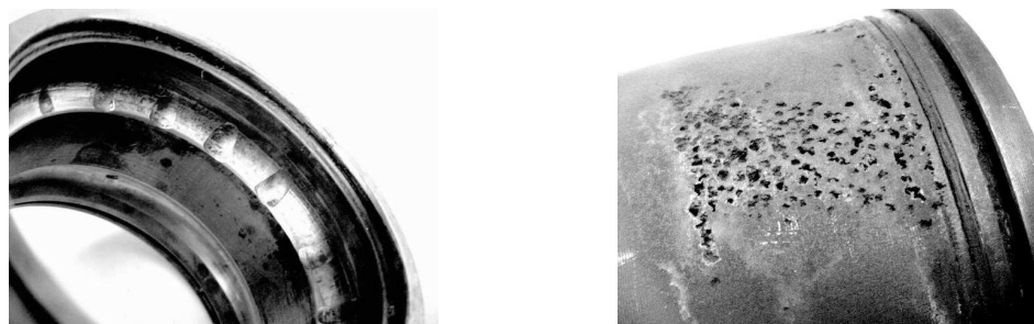
Obr. 6 – Vibrační opotřebení valivého ložiska (vlevo) a kavitační opotřebení pouzdra válce (vpravo) [21]
