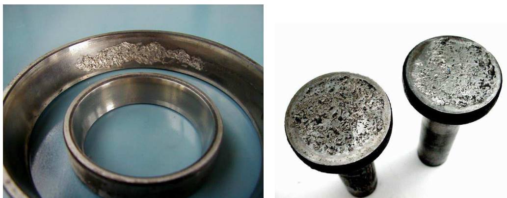
Obr.8 – Únavové opotřebení kroužku ložiska (vlevo) a zdvihátka ventilu (vpravo). [14]
